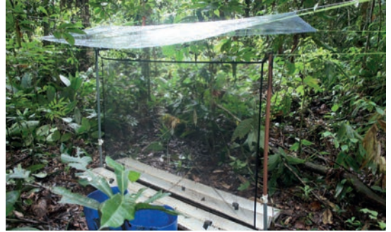
6. Trampa de Interferencia de vuelo (FIT por las siglas en inglés). Aquí vemos una pared de malla contra la cual chocan los insectos. Las bandejas en el suelo tiene agua con detergente para que los insectos no puedan escapar.
