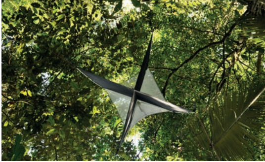
5. Trampa tipo SLAM suspendida en el soto bosque. Los insectos chocan con la trampa y caen al interior. Al tratar de escapar, tienen que subir por la paredes internas y se quedan atrapados en el frasco con alcohol que está en la parte superior.
